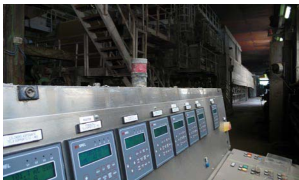
A sinistra, pulpiti modificati con l'inserimento del Digital Operator Panel SAEL.
