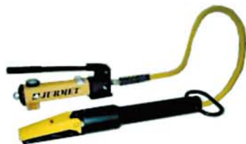
Attrezzo Idraulico ripristino Anime in Cartone
